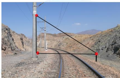
1-rasm. Favqulodda vaziyatlarni temir yo'l inshootlariga ta'siridan bashorat va monitoring qilish tizimining fizik modeli. 1,2,3 - MPU 6050 sensori.
