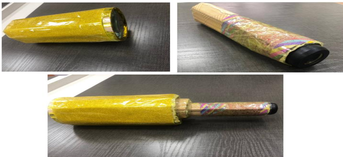
2-rasm: Obyektiv va okulyarni karton bilan birlashtirish
