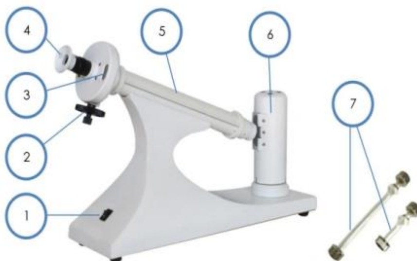
4-rasm - Polyrimetr 1 - quvvat tugmasi; 2 – analizatorning aylanma vinti; 3 - asboblari shkalasi; 4 – teleskopni fokuslash uchun mufta; 5 – kyuvetkalar uchun kamera; 6 - yorug'lik manbai; 7 – kyuvetlar
