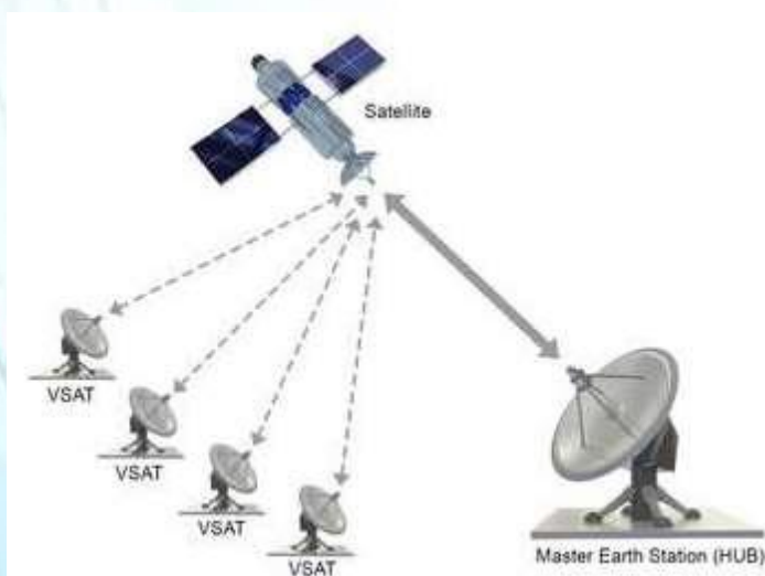
Рисунок 2.Схема организации сети VSAT топологии STAR по технологии MCPC.
