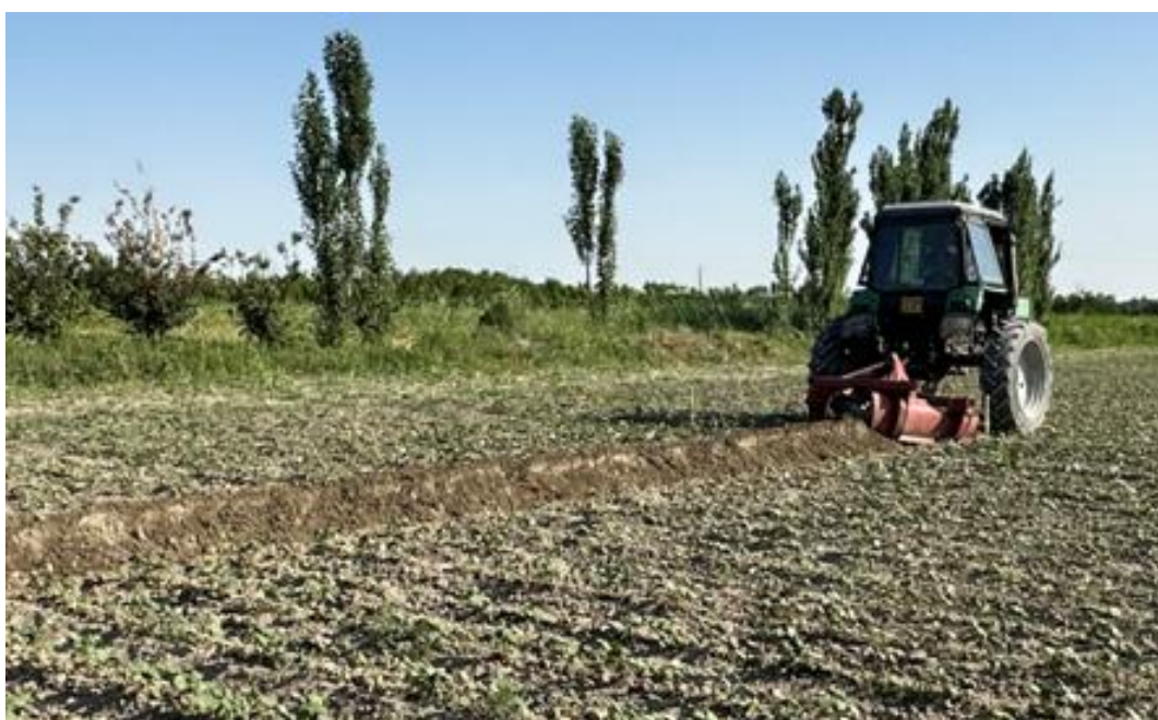
2-расм. КЗУ-0,3Д каналқозғич-текислагич қурилмаси билан кўндаланг тупроқ уюмини хосил қилиш жарёни
