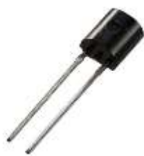
Рис.1. Общий вид полупроводникового кремниевого преобразователя температуры
