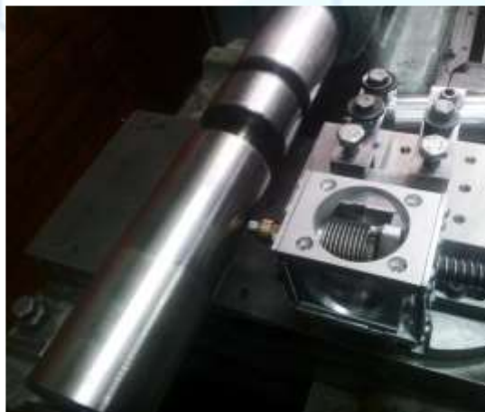
Рис. 6. Оправка пневматической пружины, установленная на станке с ресивером.
