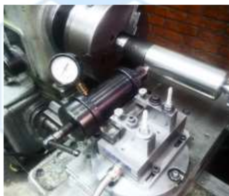
Рис. 1. Установленная пневматическая оправка
