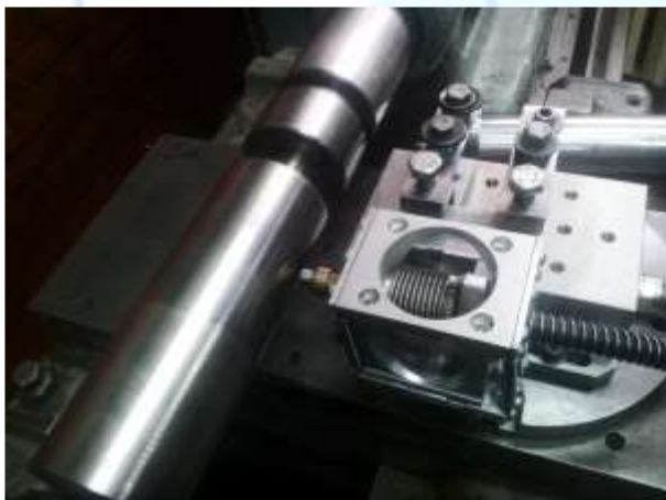
Рис. 6. Оправка пневматической пружины, установленная на станке с ресивером.
