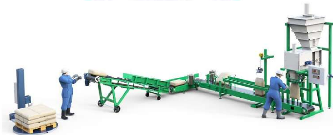
1-rasm. 50 kg gacha ochiq qoplarda past sig‘imli qadoqlash liniyasi [2].
