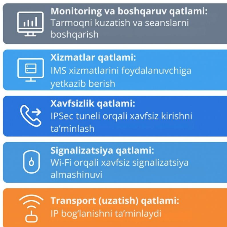
2-rasm. VoWiFi texnologiyasining qatlamli texnik arxitekturasini.
